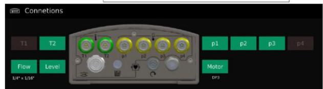
22. Выполнить обнуление - калибровку датчиков давления. На мониторе блока управления, используя функциональные кнопки на экране, переходим на следующую страницу. Выбираем тип датчиков давления – встроенные датчики, и переходим на следующую страницу – обнуления датчиков давления.
